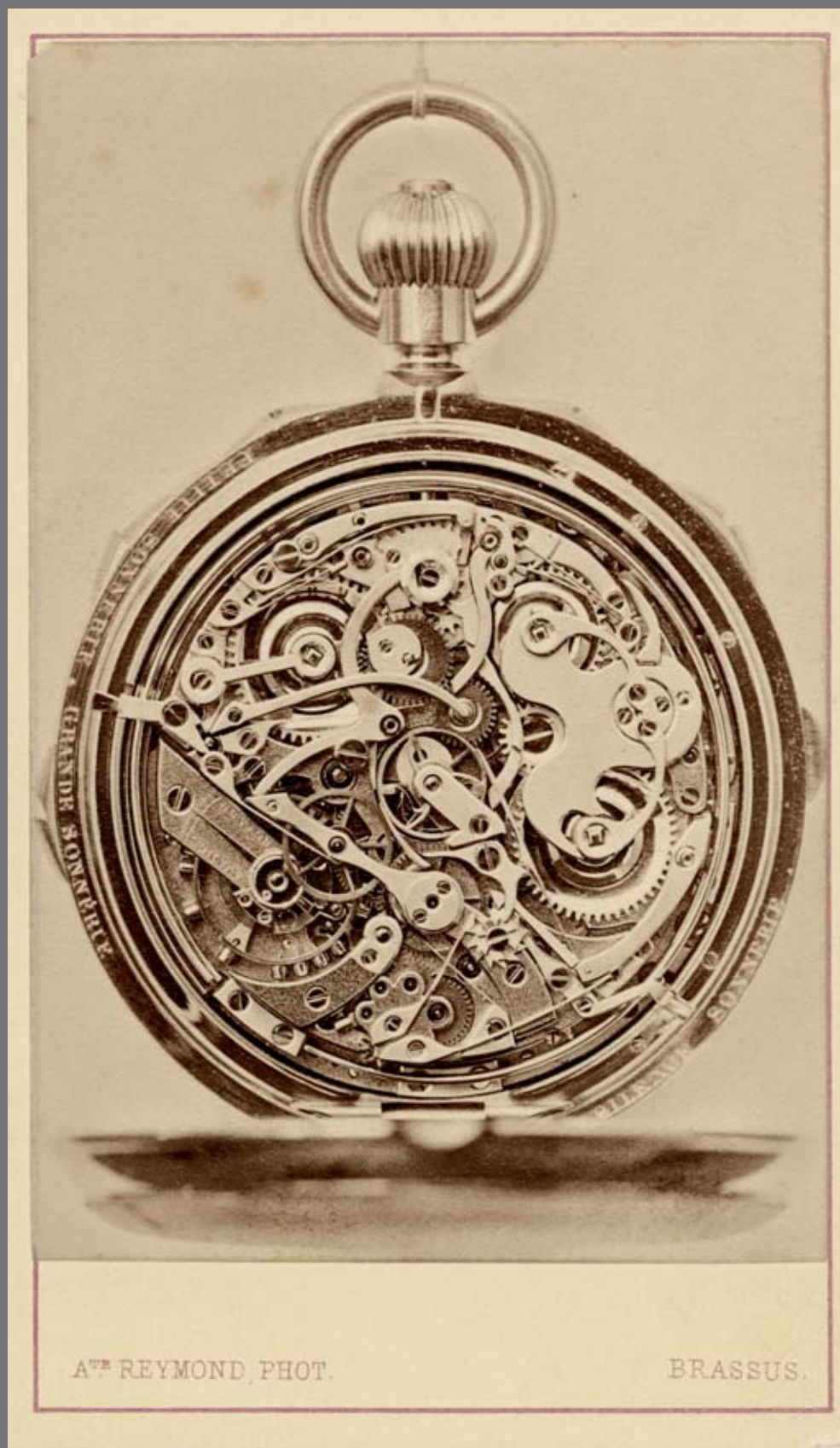
La montre à grande complication la plus connue de Louis-Élisée Piguet, qui comprend une grande sonnerie, un chronographe à rattrapante et un calendrier perpétuel.
