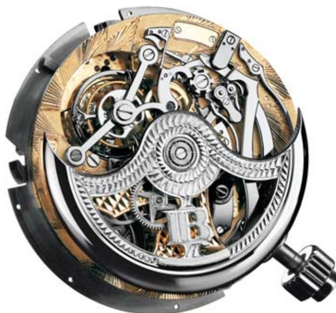
La 1735 à grande complication de Blancpain possède une répétition minutes, un tourbillon, un chronographe à rattrapante, un calendrier perpétuel et un remontage automatique.
