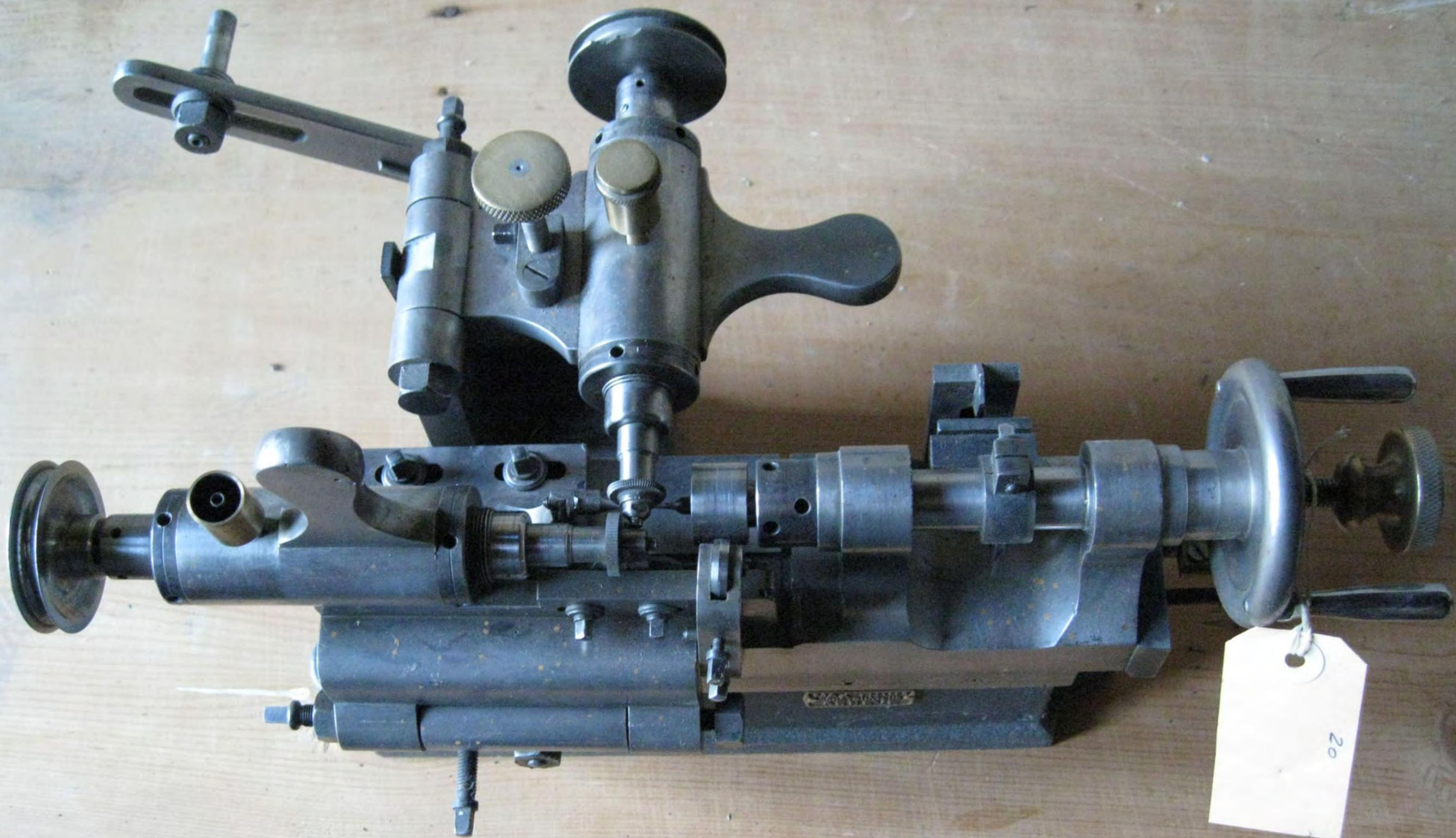
Machine à fraiser double, pour came ou arbre de barillet
