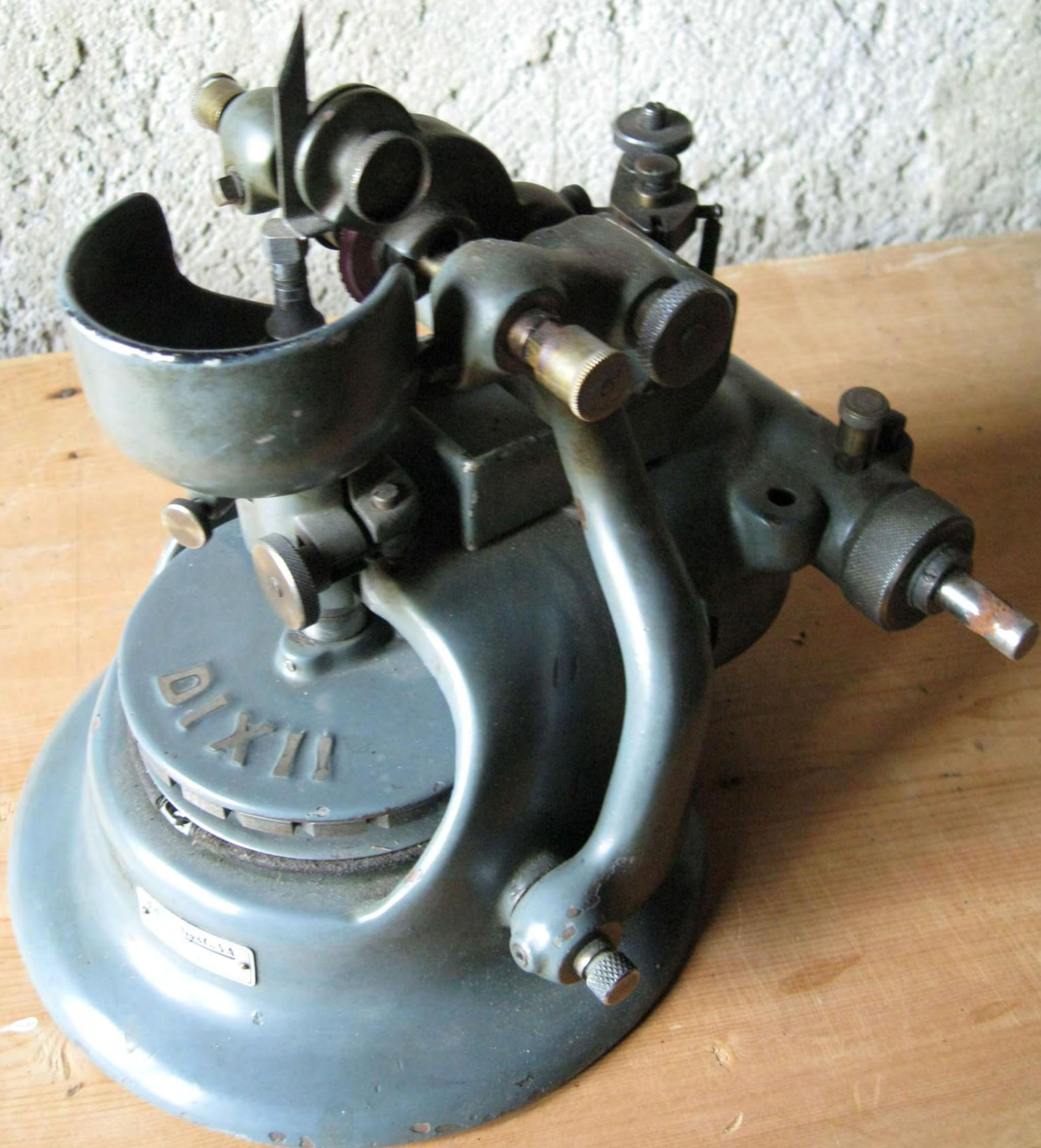
Machine à aiguiser, les fraises à tailler les dentures
