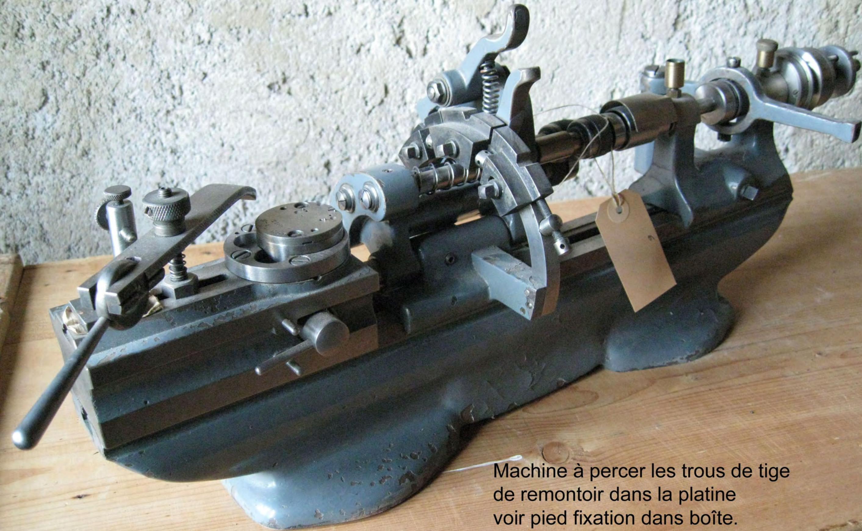
Machine à percer les trous de tige
