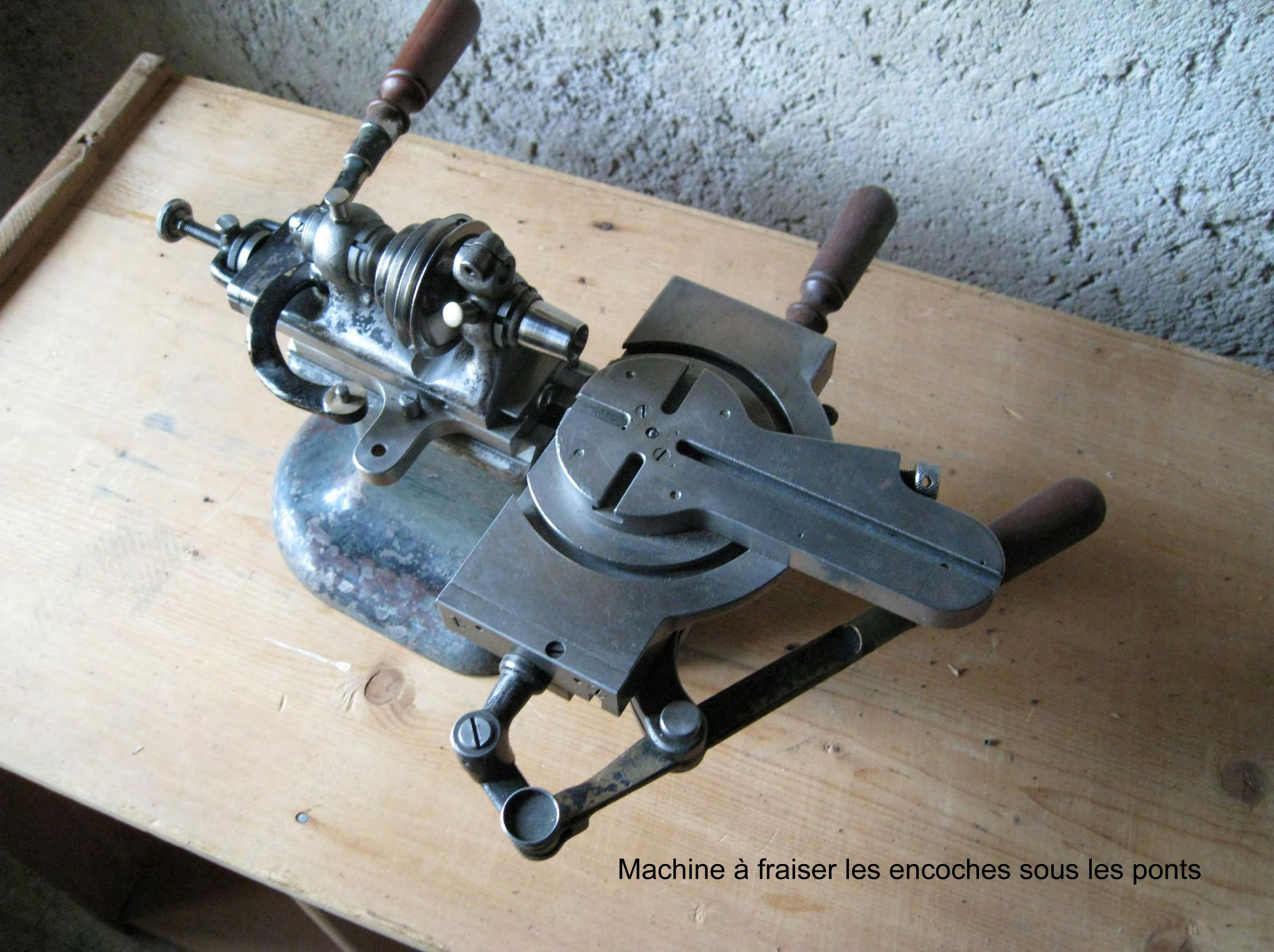
Machine à fraiser les encoches sous les ponts
