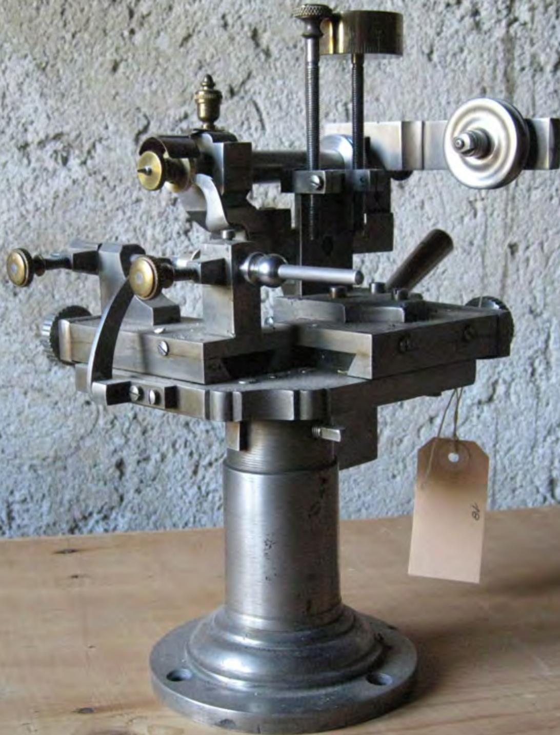
Machine à arrondir, retouche du profil de denture ou du diamètre des roues
