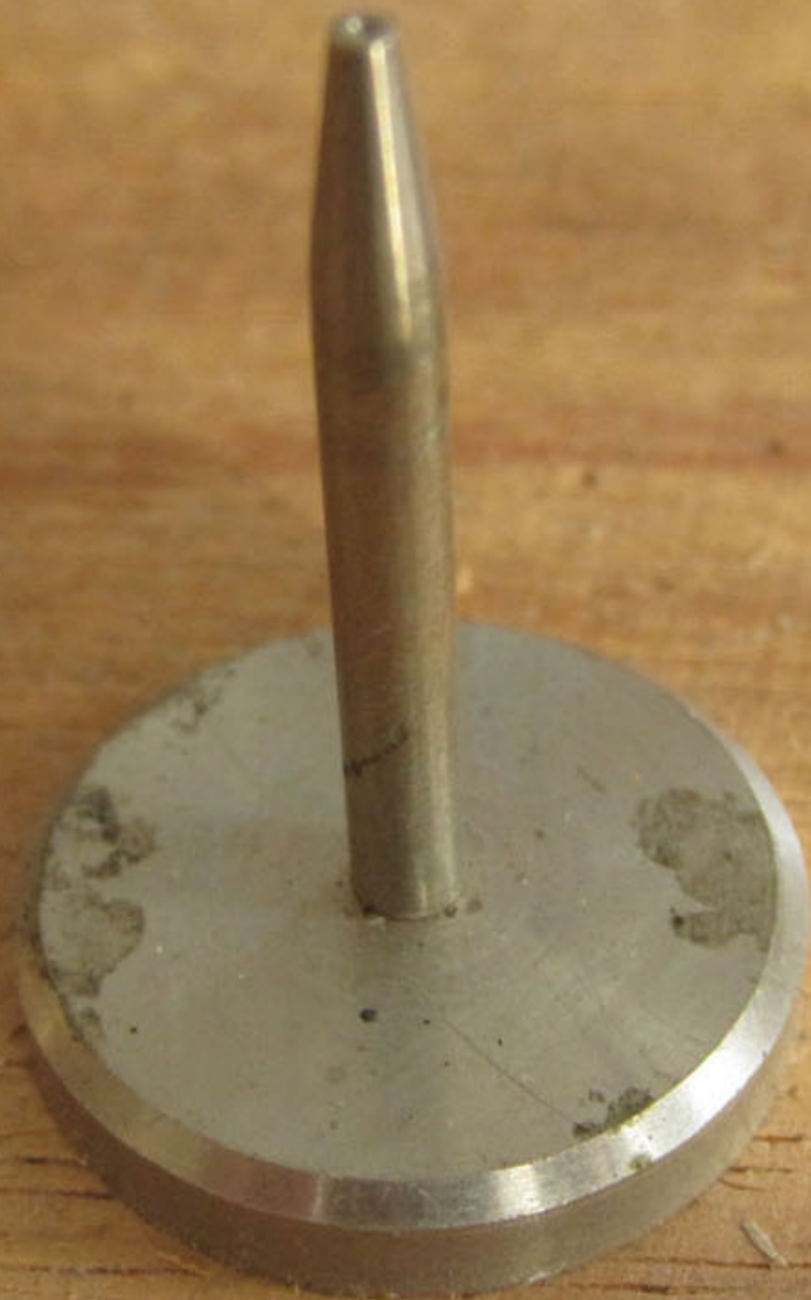
Enclume type ETVJ pour appui du pivot lors du chassage d'aiguille
