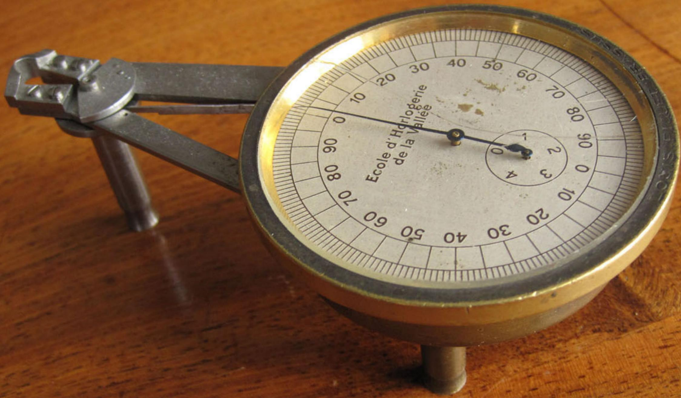
*Micromètre à cadran fait à l'Ecole d'horlogerie de la Vallée, par Frédéric Piguet*
