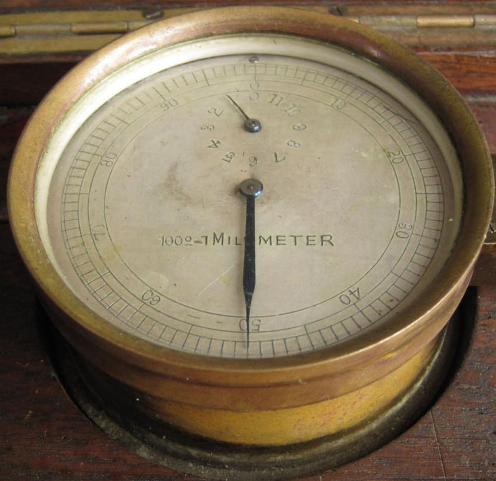
*Micromètre à cadran au 1/100ème de millimètre*
