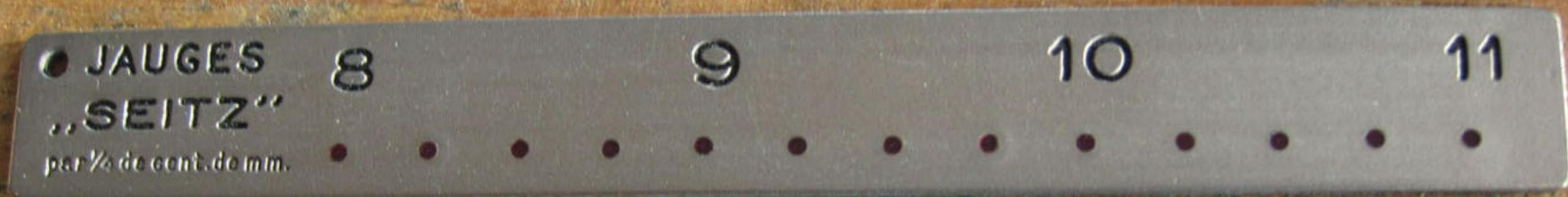
*Jauge Seitz pour mesure diamètre des pivots
