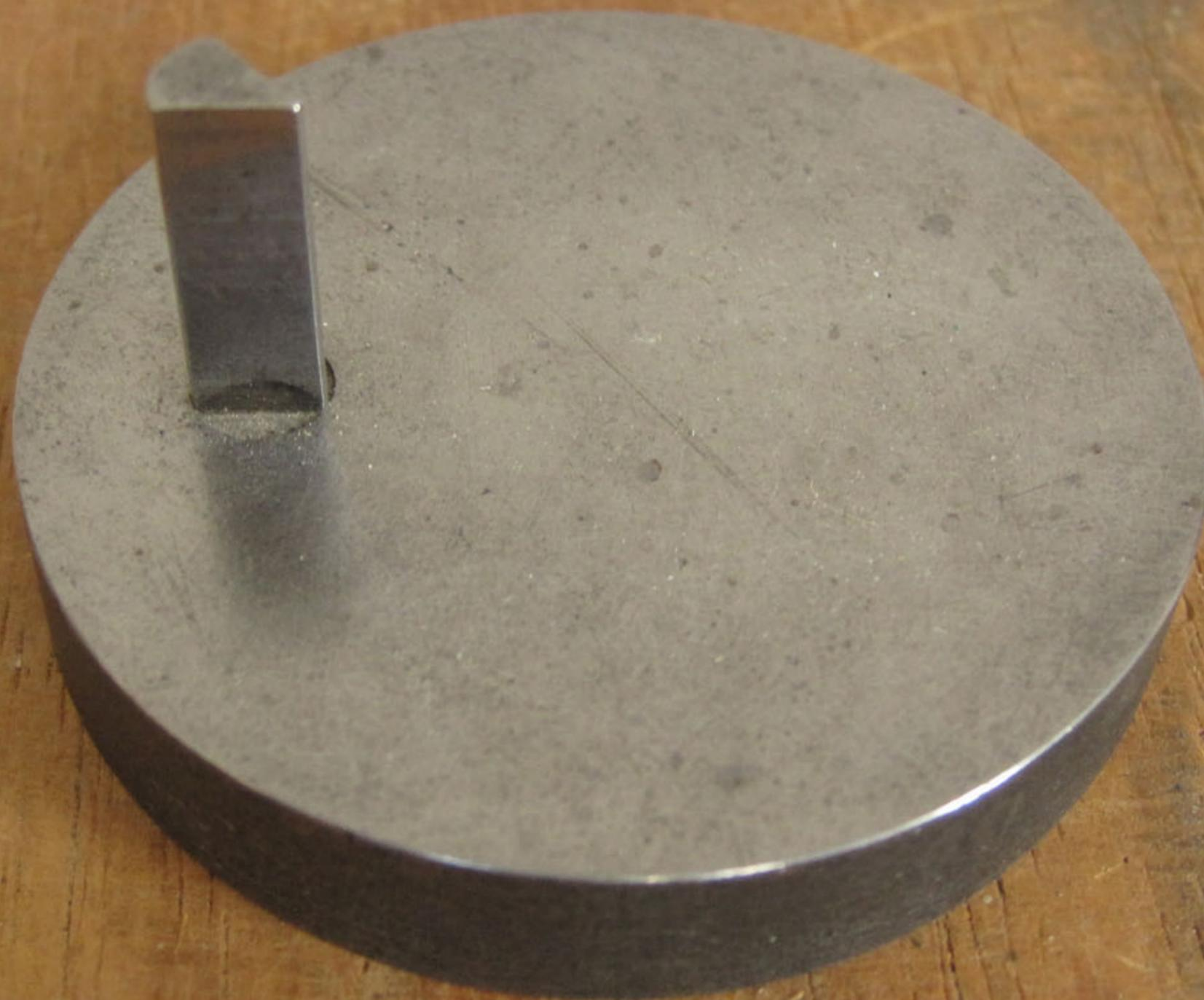
*Equerre sur plaque pour contrôle la perpendicularité de la tranche des pièces, lors du limage ou autre opération.*
