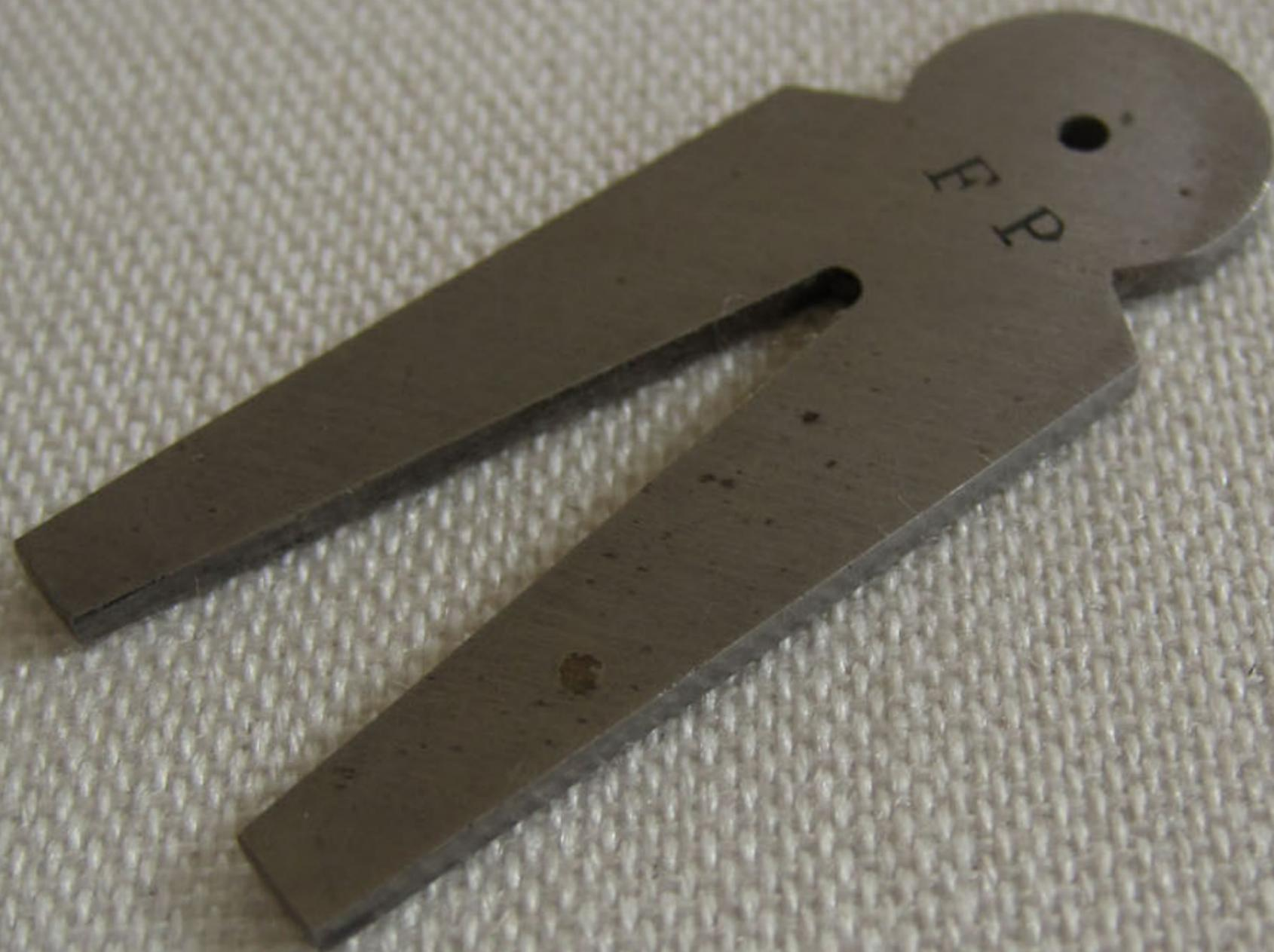
*Plaque en V à fixer sur l'étau pour le chantournage
