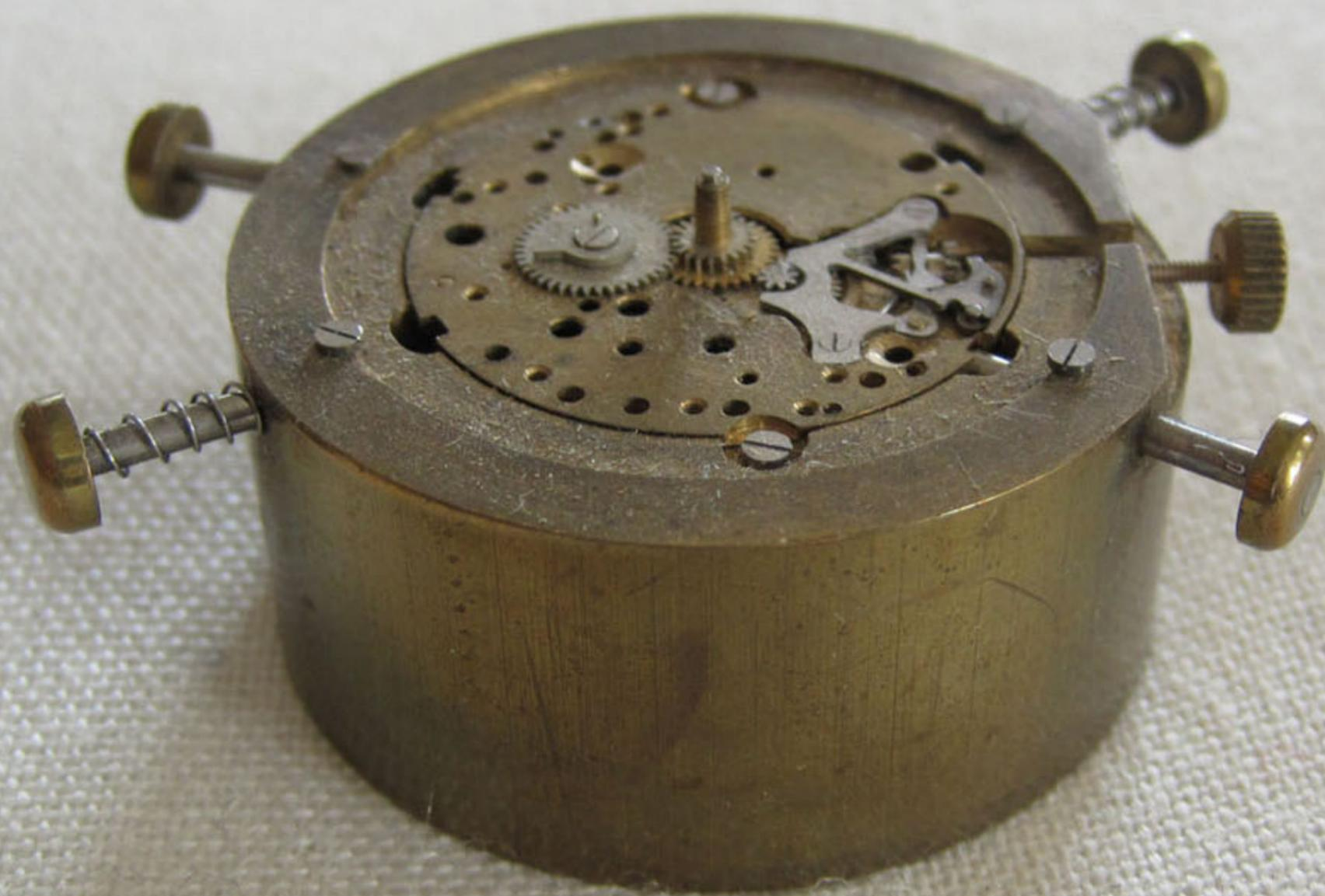
*Porte-mouvement pour contrôle des fonctions de mécanisme
