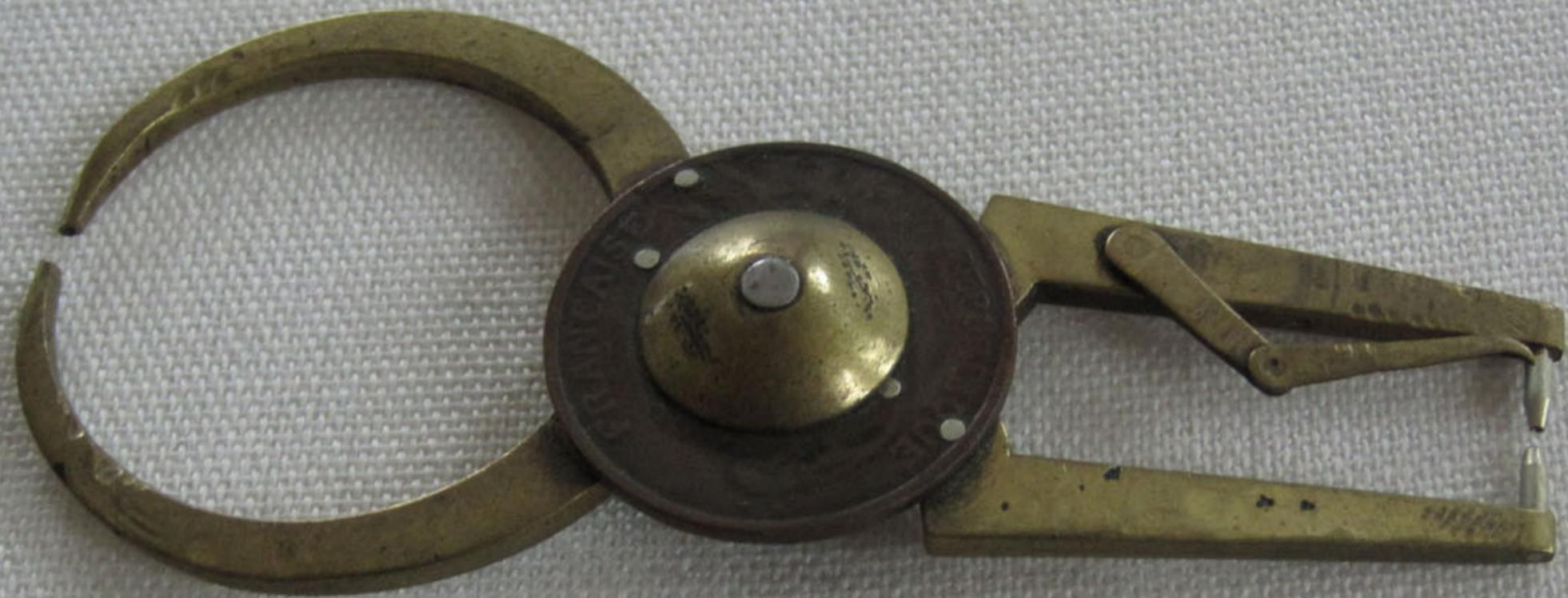
*Outil à main pour contrôler si un balancier ou un mobile tourne plat*
