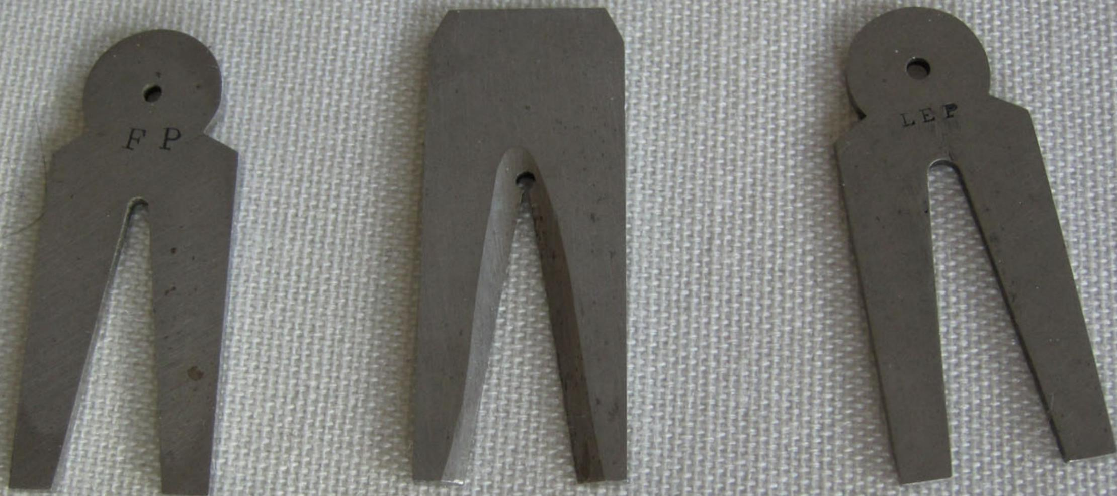
*Plauquettes en V se fixent sur l'étau pour chantourner, découper le pourtour des pièces à la scie (bocfil)*
