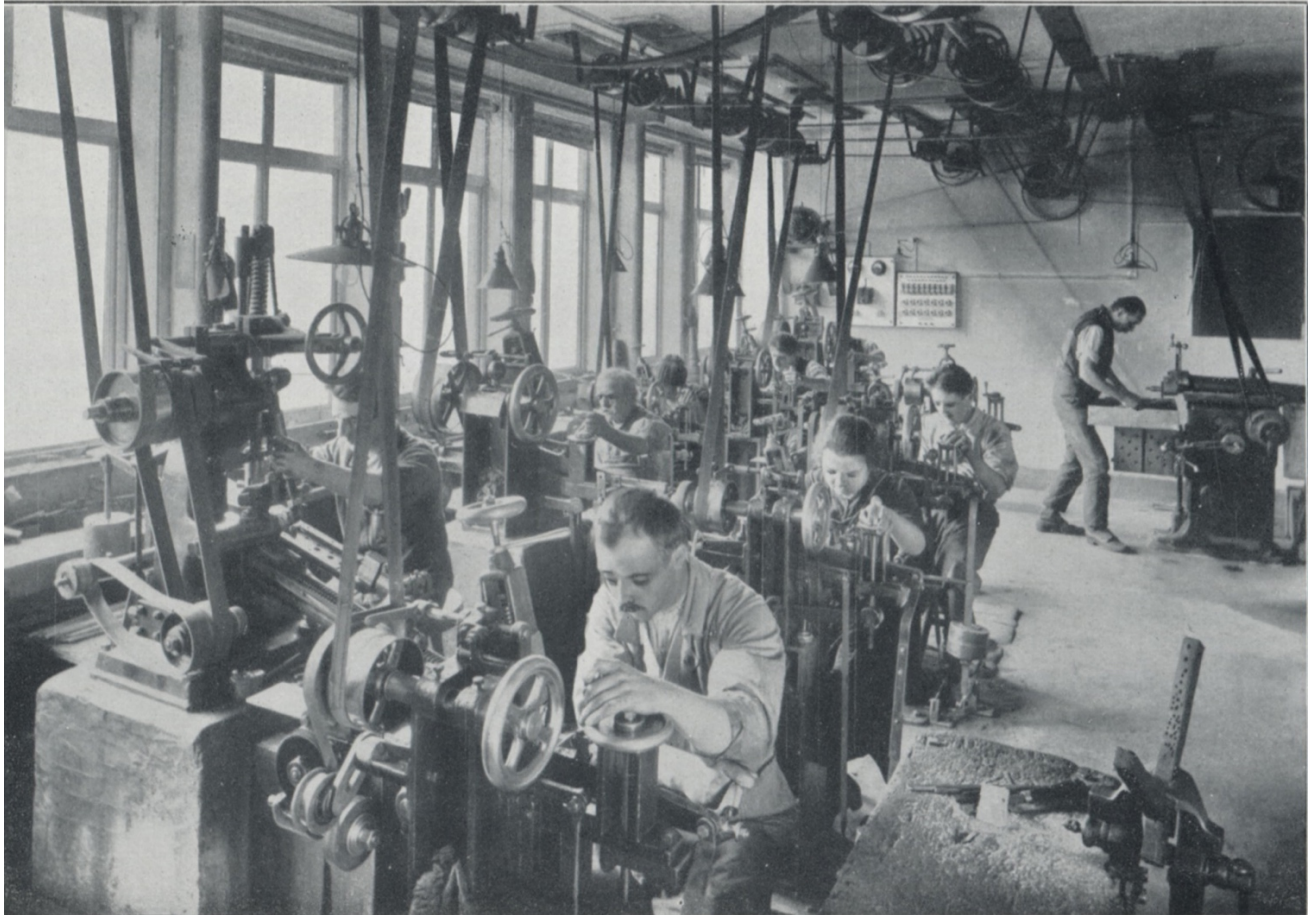
Taillage des grosses limes à la machine
