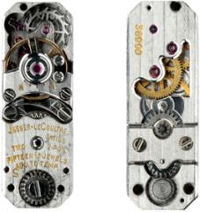
Conçu et réalisé en 1925 par Fernand David Reymond technicien horloger chez Jaeger LeCoultre & Cie, le calibre 101 sort en en 1929. Composé de 98 pièces, il ne pèse qu'un gramme, il est considéré comme le mouvement mécanique à remontage manuel le plus petit du monde.
